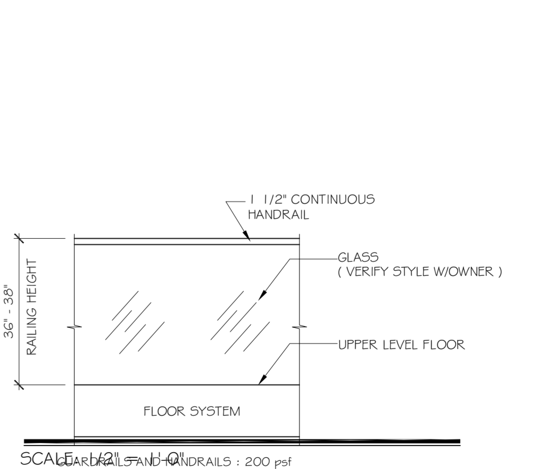
GUARDRAIL DETAIL SCALE: 1/2" = 1'-0"
